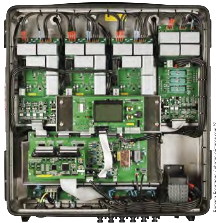
▲ Aufgeräumtes Innenleben: Im Sungrow SG15KTL werden insgesamt acht Leiterkarten verwendet, die zum Teil übereinander angeordnet sind. Entsprechend zeigt die Thermografie auch nur, was die Wärmebildkamera sehen kann. Die Werte liegen in jedem Fall in einem unkritischen Bereich.
